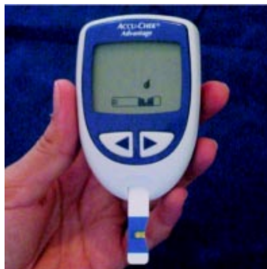
FIGURA 1. Símbolo representando uma gota de sangue no visor do glicosímetro portátil Accu-Chek® Advantage.
