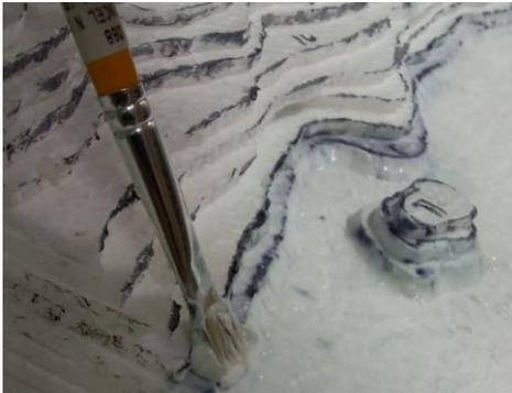
Figura 7 - Processo de aplicação da massa corrida de PVA
