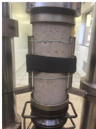
FIGURA 7: Ensaio de módulo de elasticidade com extensômetros mecânicos.
