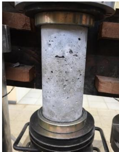
FIGURA 5: Ensaio de resistência à compressão axial do concreto.
