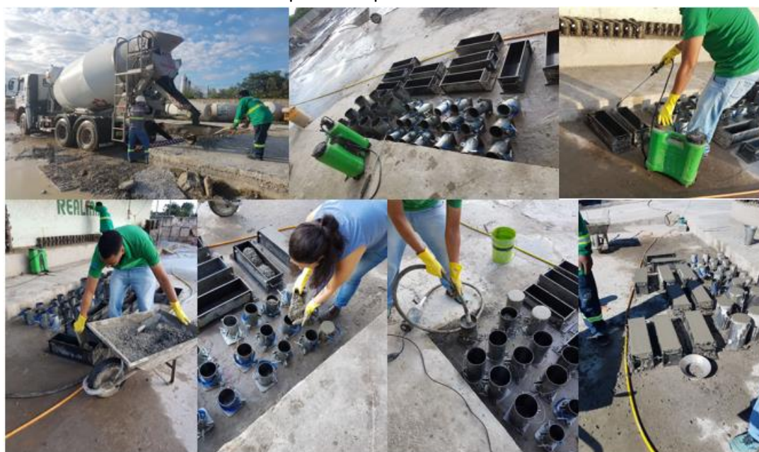
FIGURA 3: Concretagem dos corpos de prova do Traço A.
