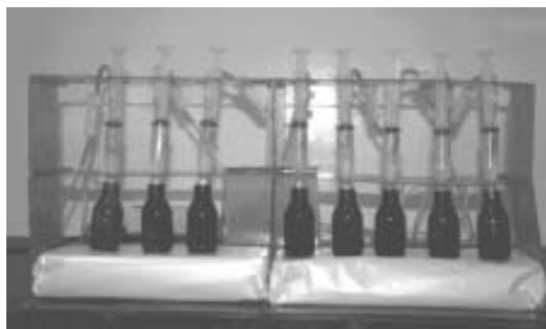
Figura 1. Aparelho controlador de fluxo, desenvolvido para o método com uso de coluna de imunoafinidade.
