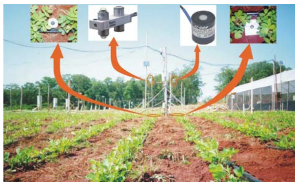
Figura 1. Disposição esquemática dos sensores radiométricos dentro da cultura de amendoim estudada.
