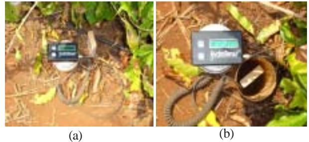
Figura 1. Leitura da umidade do solo com a sonda TDR nas camadas de 0-0,20 m (a) e 0,20-0,40 m (b).
