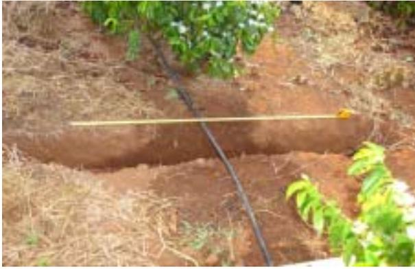
Figura 2. Método de determinação do avanço horizontal do bulbo de umedecimento.
