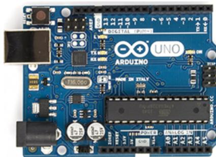
Figura 1. Plataforma de prototipagem Arduino.
