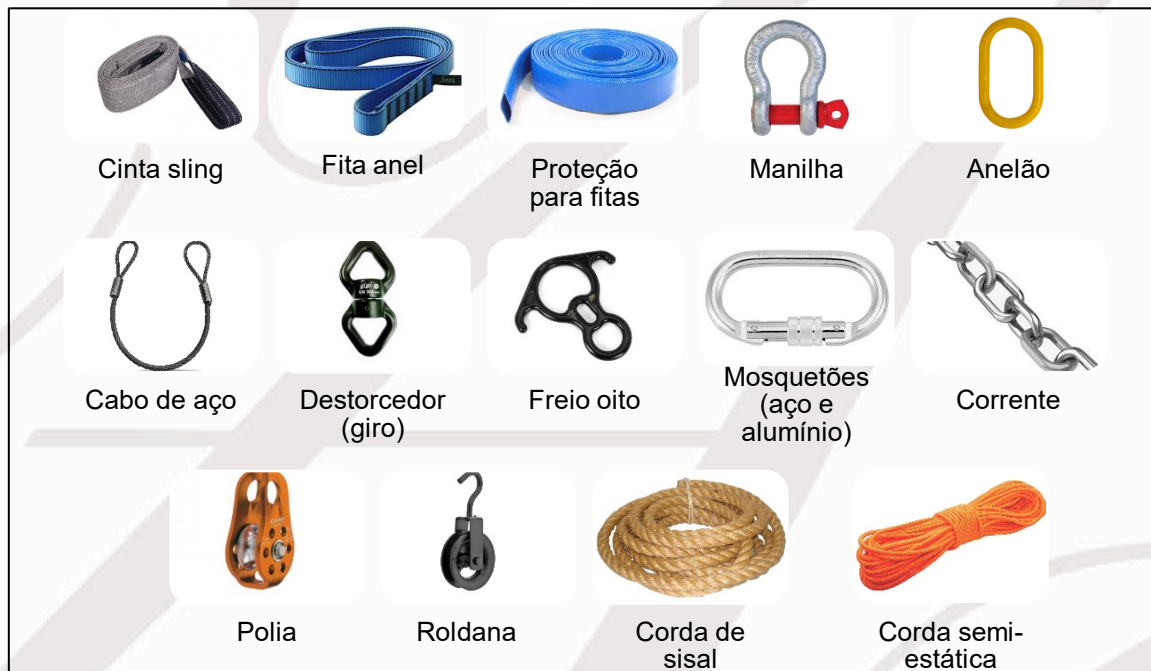
Quadro 2 - Materiais identificados nas ancoragens registradas vi .
